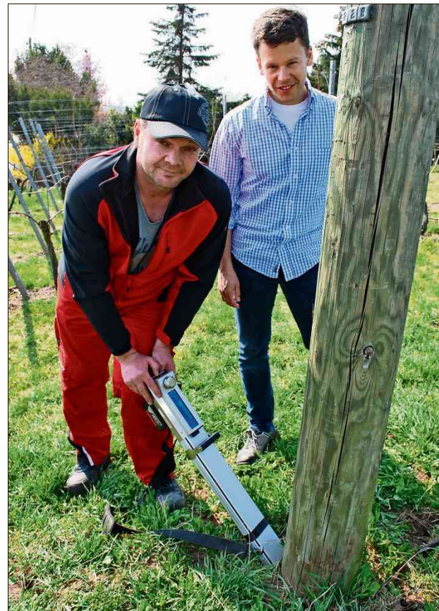
Die linke Markierung steht für die Länge des Stammes, die rechte für Alter und Herkunft (kl. Bild oben). Die Späne lassen Rückschlüsse auf den Zustand des hölzernen Masts zu. Fritz Schwab (großes Bild) nimmt den Stamm mithilfe eines Prüfgeräts unter die Lupe. Die Werte gibt er an Sven Gruschwitz von der Stuttgart Netze GmbH weiter. Fotos: Sebastian Steegmüller
