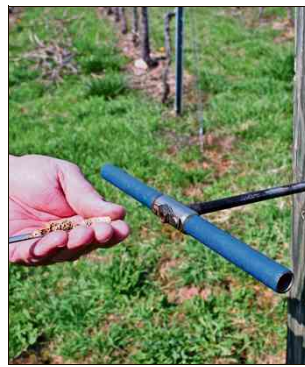
Die linke Markierung steht für die Länge des Stammes, die rechte für Alter und Herkunft (kl. Bild oben). Die Späne lassen Rückschlüsse auf den Zustand des hölzernen Masts zu. Fritz Schwab (großes Bild) nimmt den Stamm mithilfe eines Prüfgeräts unter die Lupe. Die Werte gibt er an Sven Gruschwitz von der Stuttgart Netze GmbH weiter. Fotos: Sebastian Steegmüller
